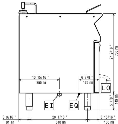
EI = Conexión eléctrica (energía)
